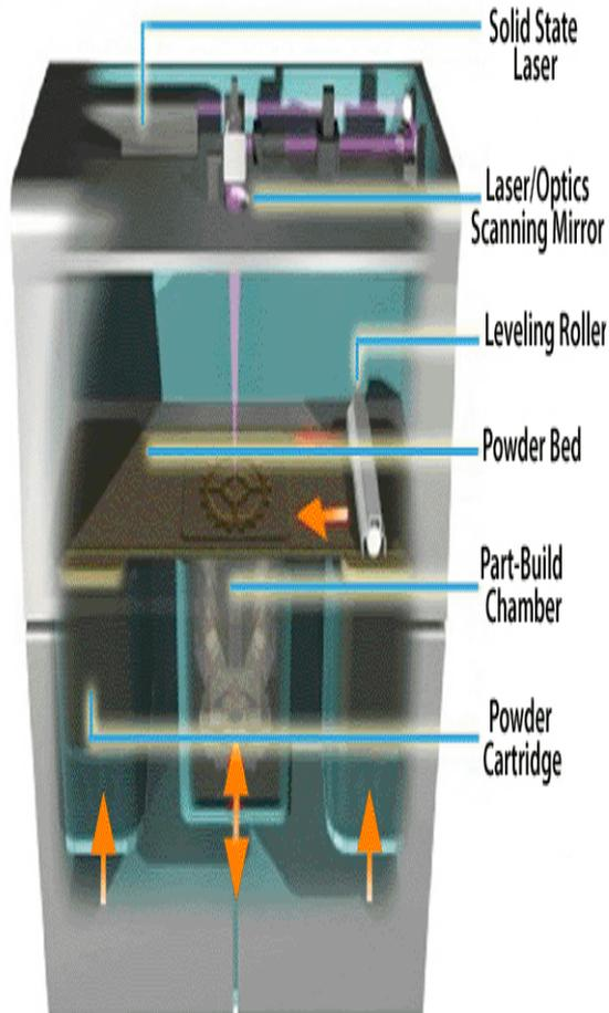
FIG: SELECTIVE LASER SINTERING
